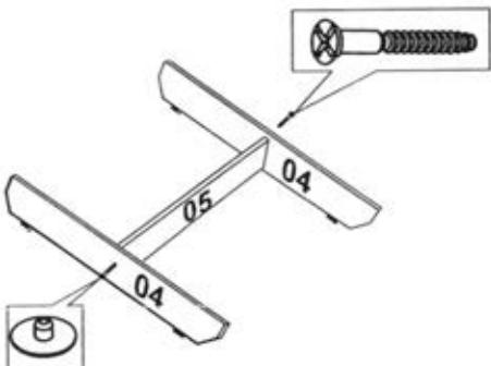
Крепить стенки опорные 04 к стенке продольной опорной 05 на шканты и евровинты. На евровинты установить заглушки.
