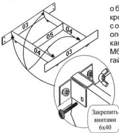
Царги 03, предварительно оборудованные цокольной кроватной стяжкой, установить на собранную конструкцию из опорных стенок 04 и 05 и закрепить, как показано на рисунке, винтами М6х40 при помощи барашковой гайки.
