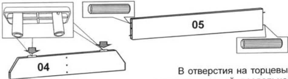
В отверстия на кромке опорных стенок 04 установить наконечники.
