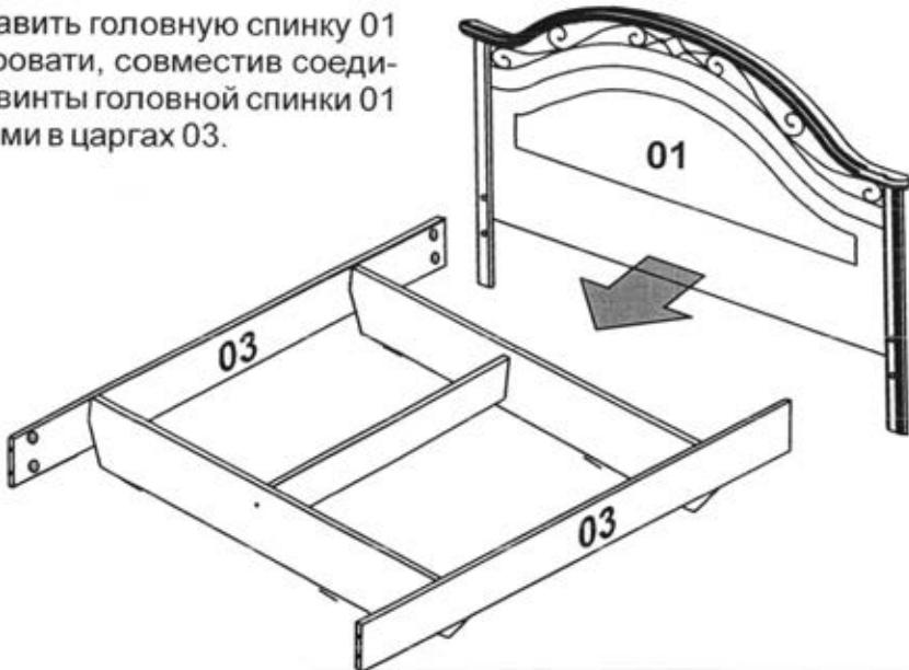
Установить сегменты в отверстия царг 03 как показано на Рис. 1. Винт стяжки затянуть любым подходящим инструментом (гвоздь, шило).
